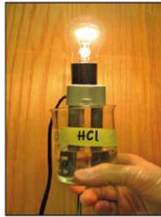
▲ شكل (١٣) الحمض القوي يوصل التيار الكهربى بدرجة أكبر من الحمض الضعيف
